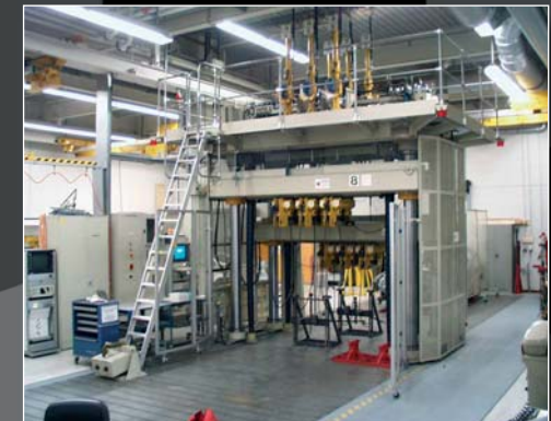
Prüfstand für Gurtverankerung ▼
